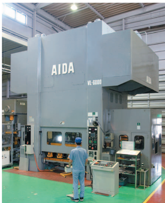
パーティカルリンク(VL) 600tプレス 600t (VL) Press
